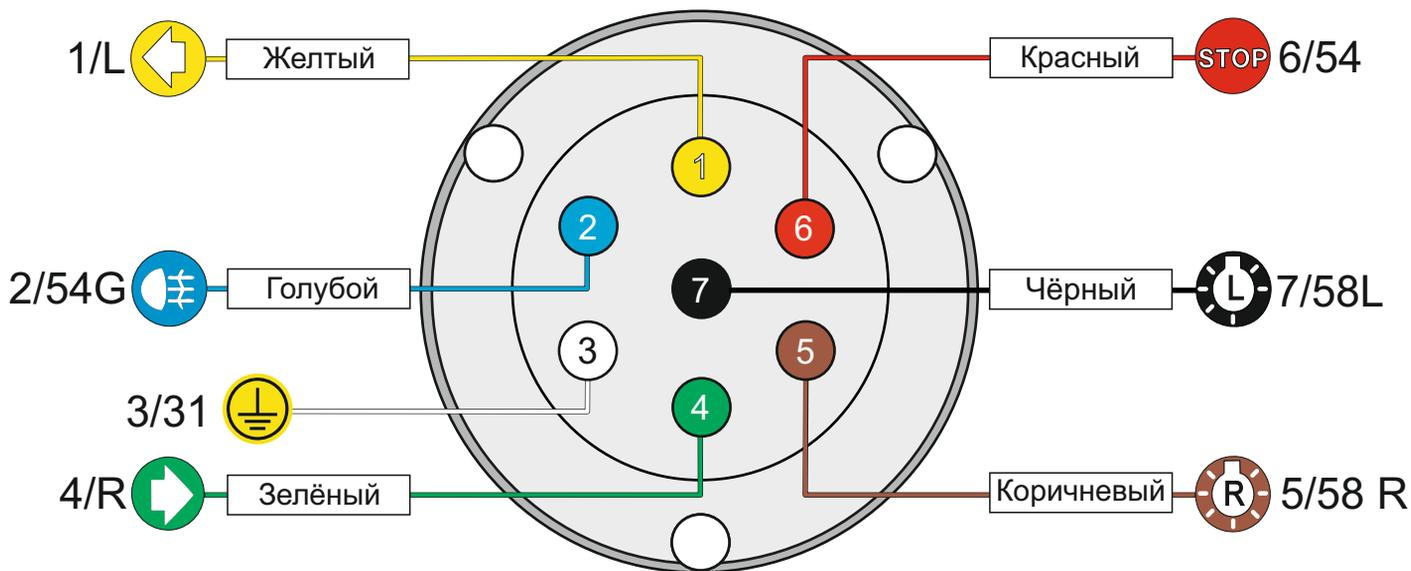
После монтажа проведите проверку правильности присоединения электропроводки тестером с нагрузкой или лампами соответствующей мощности. Сборку производите в обратном порядке.
